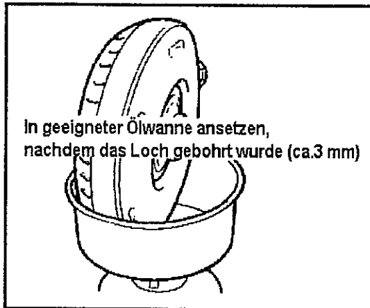
Abb. 10-8 Ablassen des Getrieböls aus dem Drehmomentwandler
