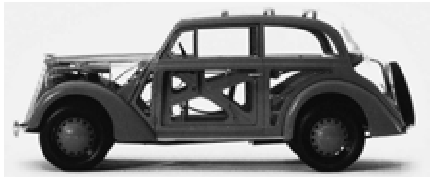
Glas-Haus – ein solches Modell mit Plexiglaspartien anstelle der Karosserie-bleche sorgte für die Sensation der Berliner Automobilausstellung 1935
