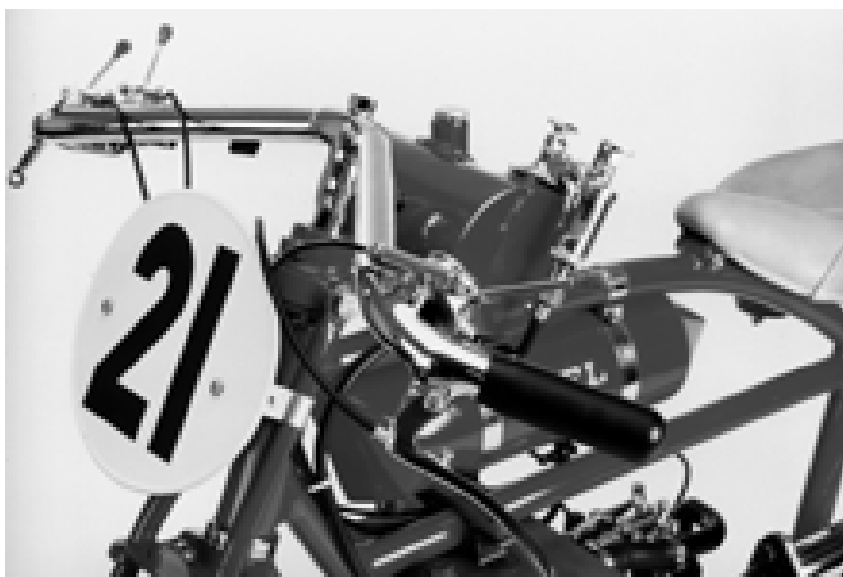
Zwischen den beiden oberen Querrohren des Rahmens hängt der aus dem Motor-Fahrrad stammende Kraftstofftank, der aus Platzgründen jedoch umgedreht, mit der Spitze nach hinten, montiert ist. Darüber sitzt, quer zur Fahrtrichtung, der Öltank. Dieser fungierte vorher in einem 150er-Knickrahmen-Modell als Kraftstoffbehälter. Spitze ab, Flansch für die Handölpumpe drangefertig war die Laube
