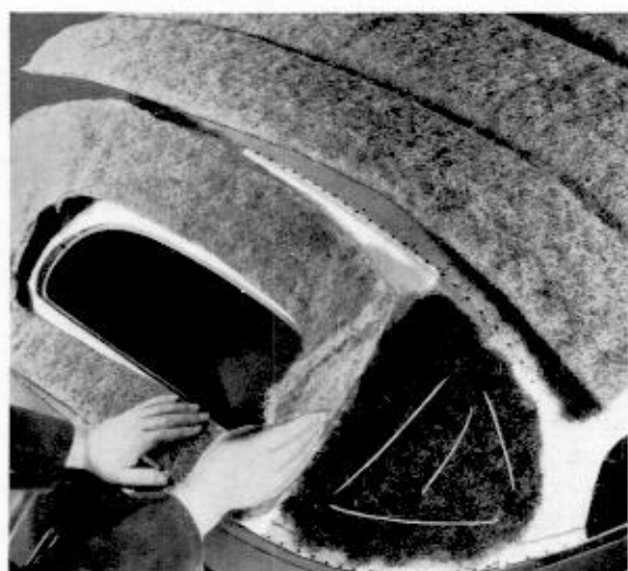
3 - Gummihaarmatte am Rückblickfenster vom Eckspiegel bis zum Rückwandbügel ziehen und
