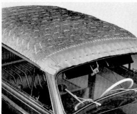
7 - Die ausgeschnittenen Keile links und rechts in der Gummihaarmatte im Bereich des Hauptspiegels und die Vertiefung an den äußeren Kanten zwischen der Dach- und Rückwandmatte leicht mit Polstermaterial ausgleichen, das mit Lasierstichen anzunähen ist.
