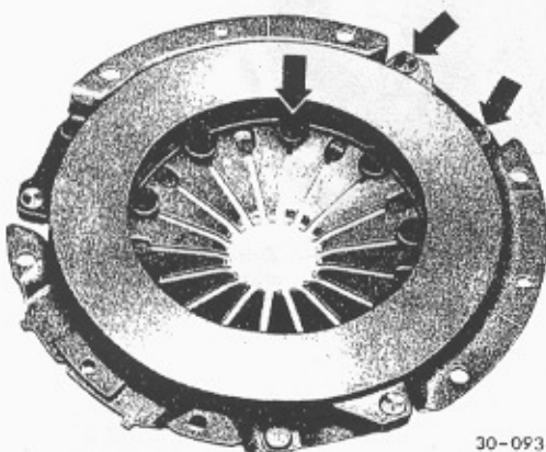
Abb. 3 Federverbindungen zwischen Druckplatte und Deckel auf Risse, Nietbefestigungen auf festen Sitz prüfen
