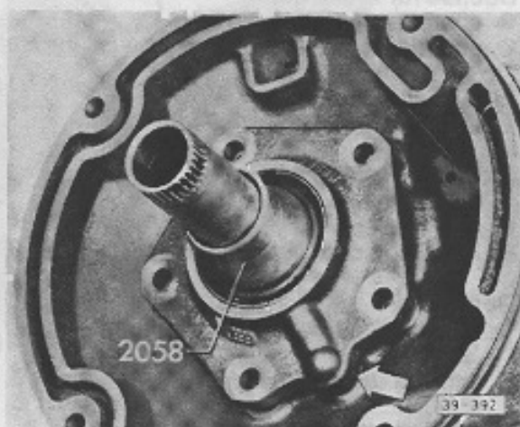
Abb. 4 Deckel für Triebwelle einbauen
