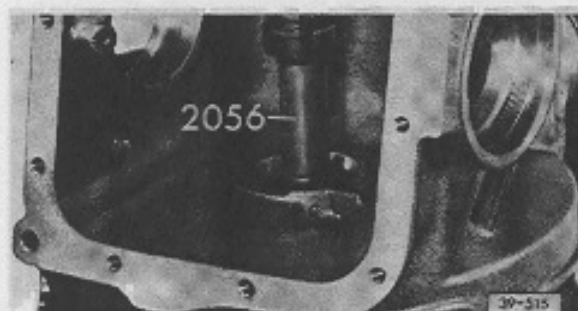
Abb. 9 Dichtring für Triebwelle eintreiben Dichtlippe zeigt zum Drehmomentwandler.
