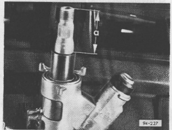
Abb. 5 Abstand zwischen Oberkante Hülse für Lenkrohr und Lenksäule oben einstellen
