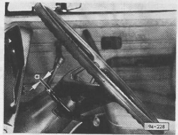
Abb. 6 Abstand zwischen Lenkrad und Blinkerschalter prüfen
