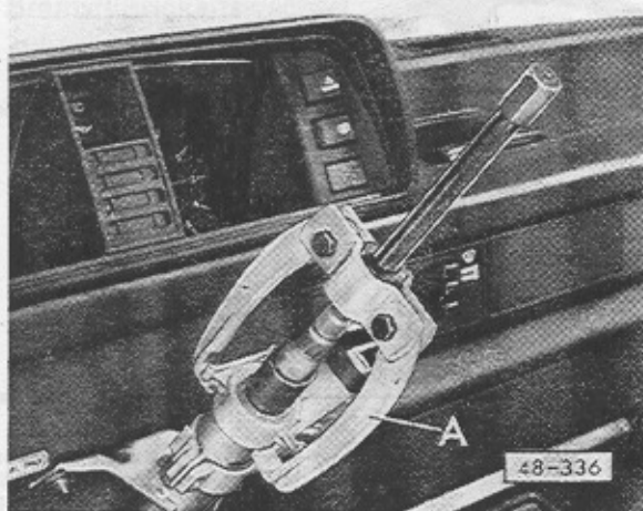
Abb. 1 Lenkschloßgehäuse mit Abstandshülse abziehen
