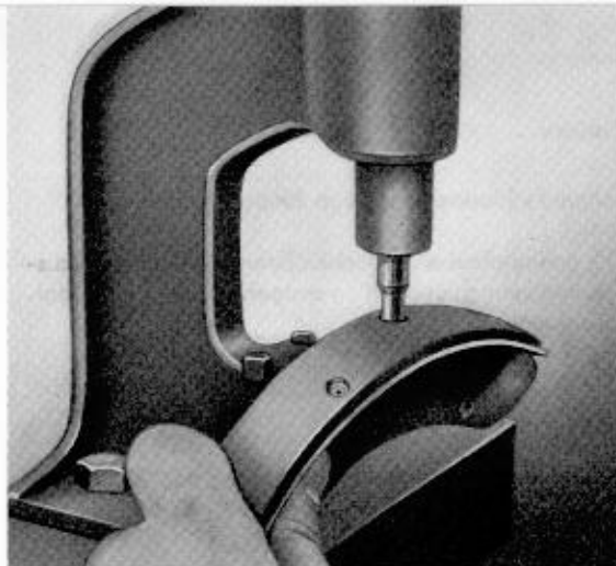
6 - Belag nötigenfalls an beiden Enden auf etwa 5 mm Länge abschrägen. Scharfe Kanten an den Anlaufseiten abrunden.
